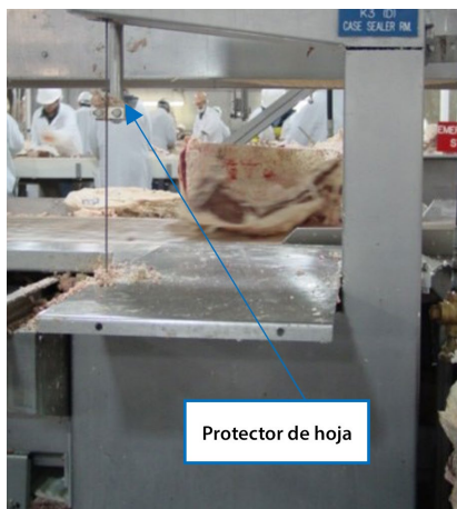
Figura 2: Un protector de hoja de sierra de cinta colocado a la altura adecuada, a no más de un cuarto de pulgada por encima de la parte superior de la parte más alta de la pieza que se está cortando.
