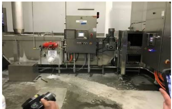
Figura 1: Seis trabajadores murieron a causa de una atmósfera con poco oxígeno cuando se liberó nitrógeno del equipo de congelación rápida.
